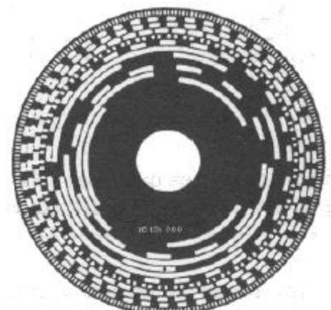
Disque 12 pistes d'un codeur optique absolu
